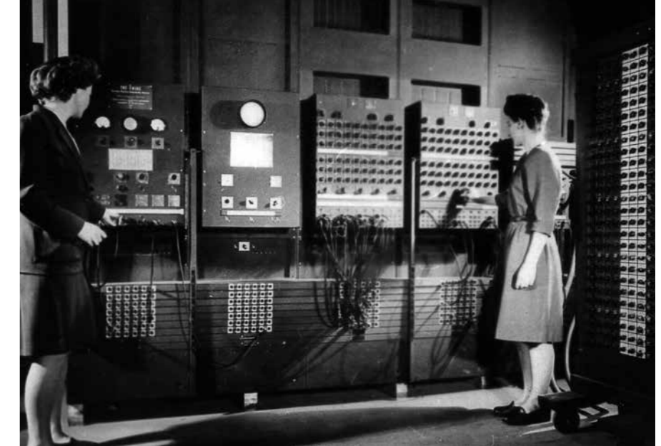
ENIAC Mainframe Computer. Teil der Maschine von 1945, die als der erste General Purpose Computer bezeichnet wird, eine militärische geheime Entwicklung an der University of Pennsylvania. Hier: Zwei Frauen bedienen das Hauptschaltfeld des ENIAC. Links: Betty Jennings (Mrs. Bartik). Rechts: Frances Bilas (Mrs. Spence)
